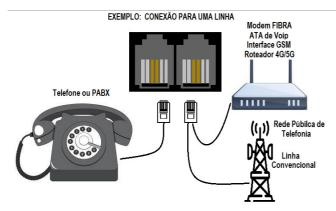
Conectar o cabo do telefone em qualquer uma das entradas do conector duplo do aparelho e conectar **o** cabo proveniente da linha telefônica na outra entrada do mesmo conector duplo.
